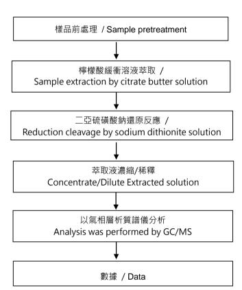
【測試方法/Test method: ISO 14362-1】
