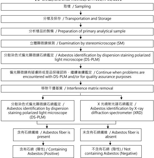
石綿鑑定分析流程圖 / Analysis flow chart for determination of Asbestos 【參考方法(Reference method): EPA 600/R-93/116】
